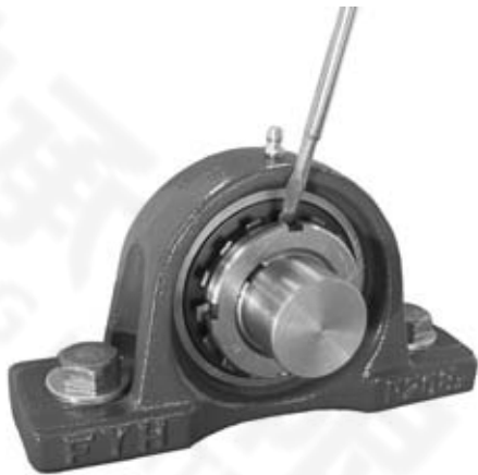
图14.8 折弯垫圈的爪 (锁紧螺母的防松)
