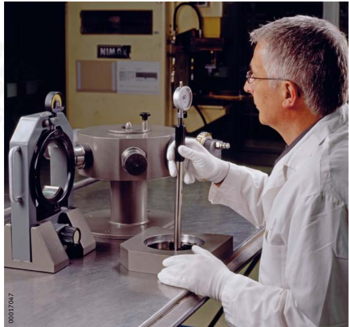
图 2 测量外圈的滚道直径
