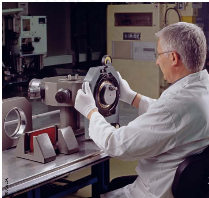
图 4 包络圆量规的位置调整
