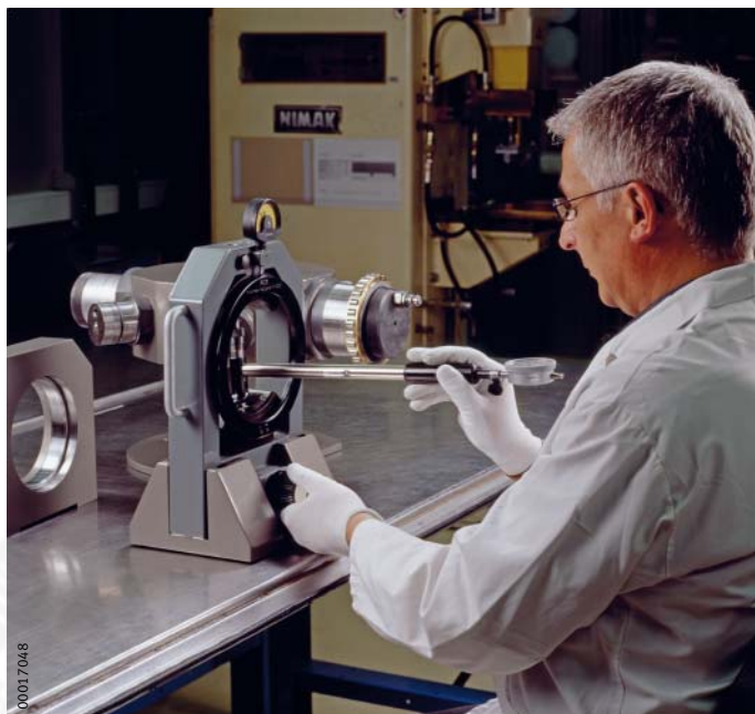
图 3 将测得的直径传递给包络圆量规
